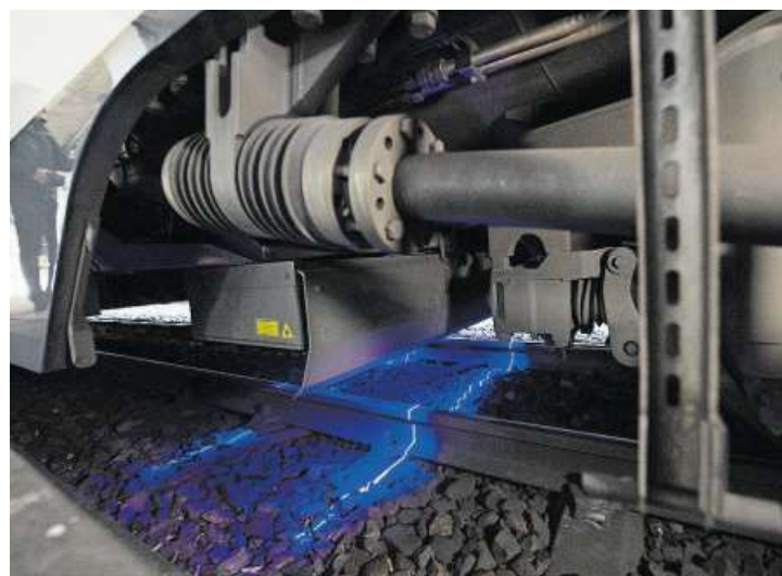
Diese Fink-Komposition der Zentralbahn (oben) hat es in sich. Die am Zug installierten Laser vermessen die Schienen millimetergenau (Bild unten links). Die Daten können Zentralbahn-Verantwortliche auch auf ihrem Smartphone abrufen. Bilder: Eveline Beerkircher (Luzern, 21. Februar 2019)
