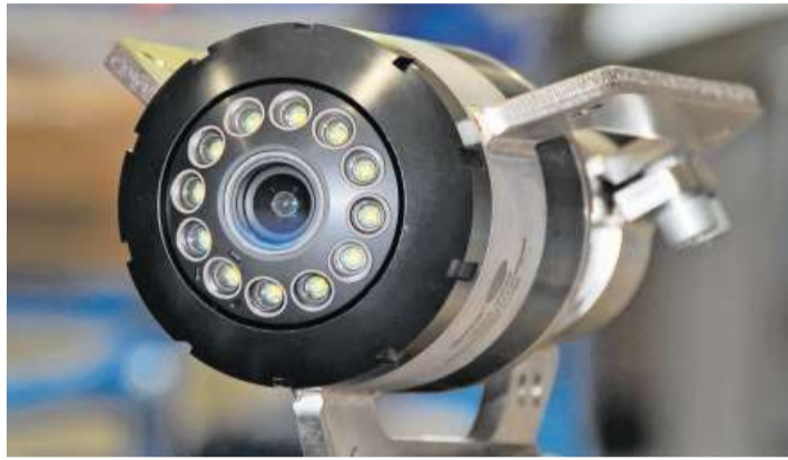
Die Kamera-Düse der Giswiler Firma Enz.
