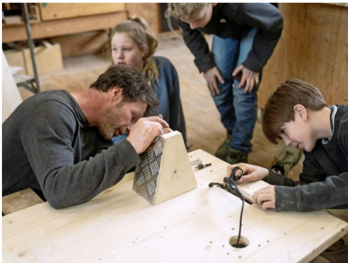
Fussraster und der Seilzug für die Lenkung werden eingepasst.
